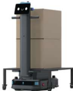
Modalità Sollevamento Carrelli o scaffali dim max 1200 x 1000 mm
